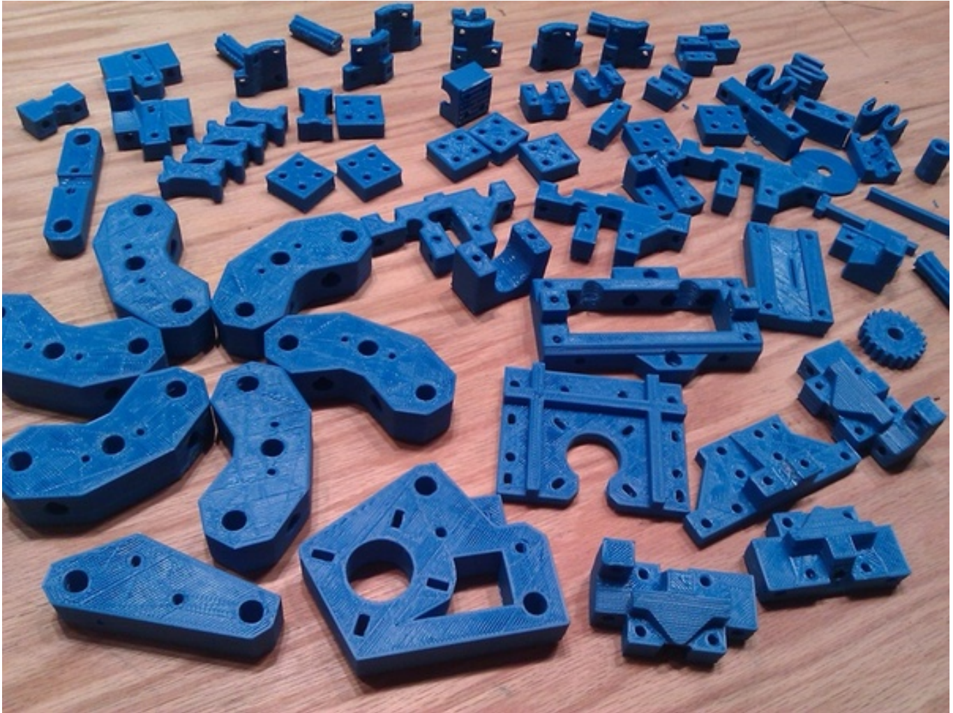
أجزاء الطابعة "ريب راب ميندل" المصنعة بواسطة الطباعة ثلاثية الأبعاد. المصدر: makerbot/Flickr
