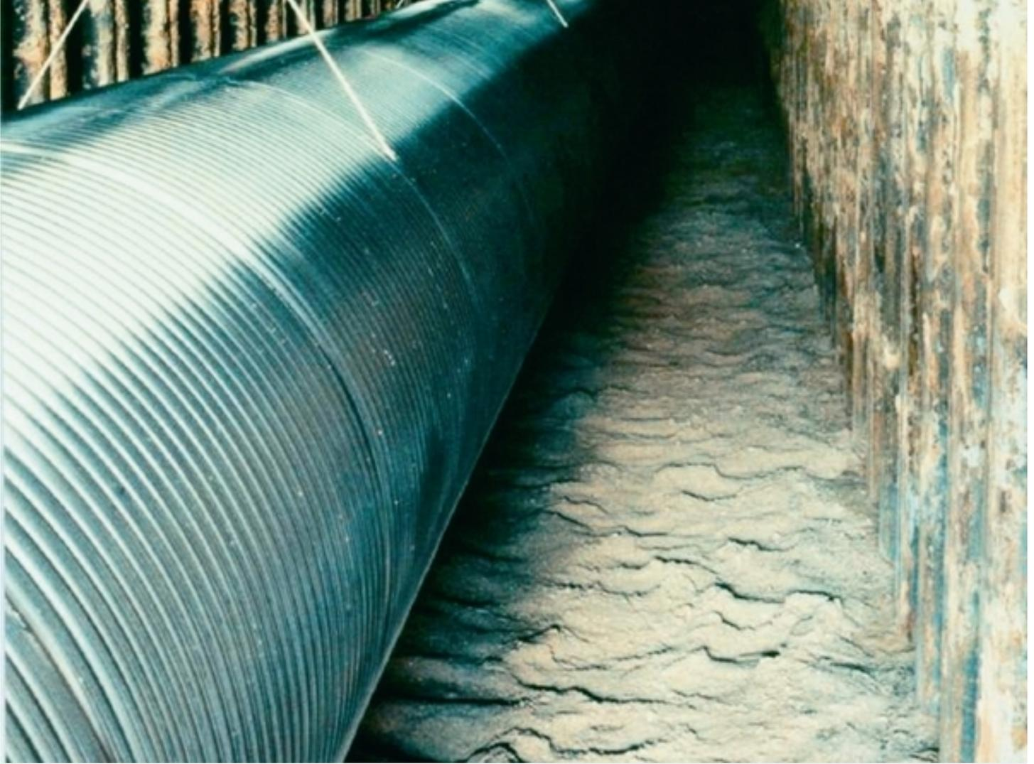
تحت الأرض: تسير أشعة الضوء تحت الأرض في الكاشف الليزري GEO600 عبر أنابيب الفولاذ المقاوم للصدأ المتموجة التي يبلغ قطرها 60 سم وسماكة جدرانها 0.9 ملليمتر (في الأيمن). المصدر: MPI for Gravitational Physics / University of Hanover
