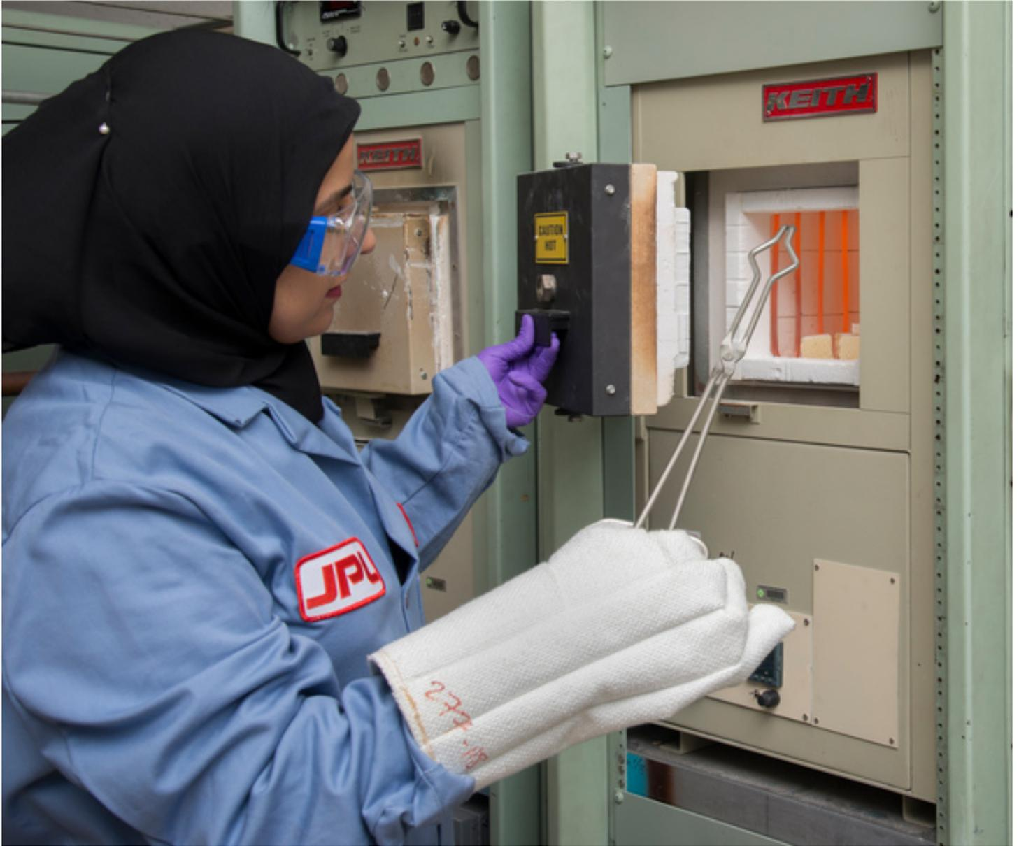
تظهر في الصورة خبيرة التكنولوجيا صباح باكس Sabah Bux من مختبر الدفع النفاث JPL وهي تستخدم الفرن الحراري في عملها لتطوير مادة كهروحرارية تقوم بتحويل الحرارة إلى كهرباء. حقوق الصورة: NASA/JPL-Caltech
