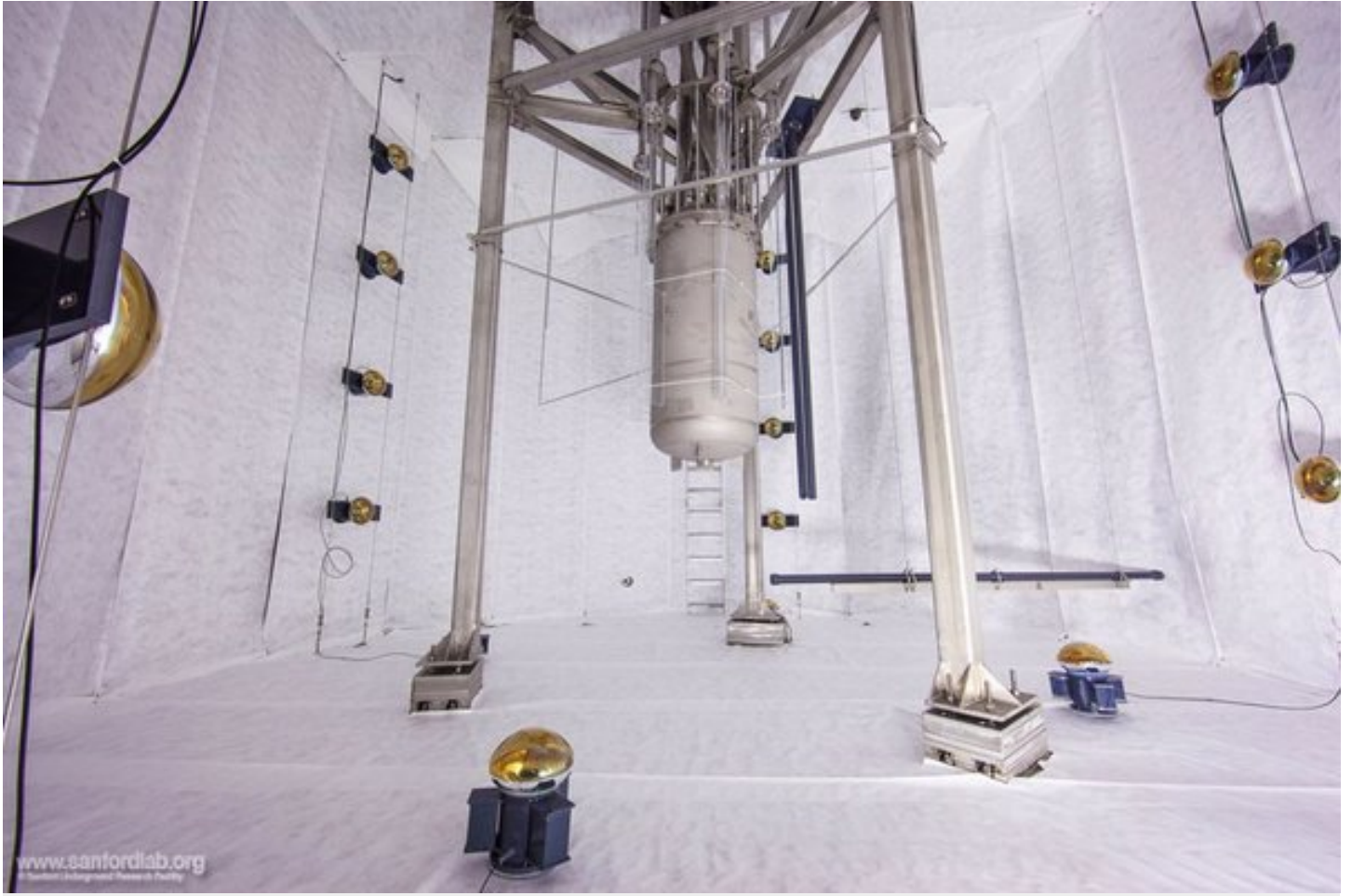
خزان LUX قبل أن يتم ملؤه بـ 70,000 جالون من المياه غير المتأينة. حقوق الصورة: Matthew Kapust, Sanford Underground Research Facility, © South Dakota Science and Technology Authority
