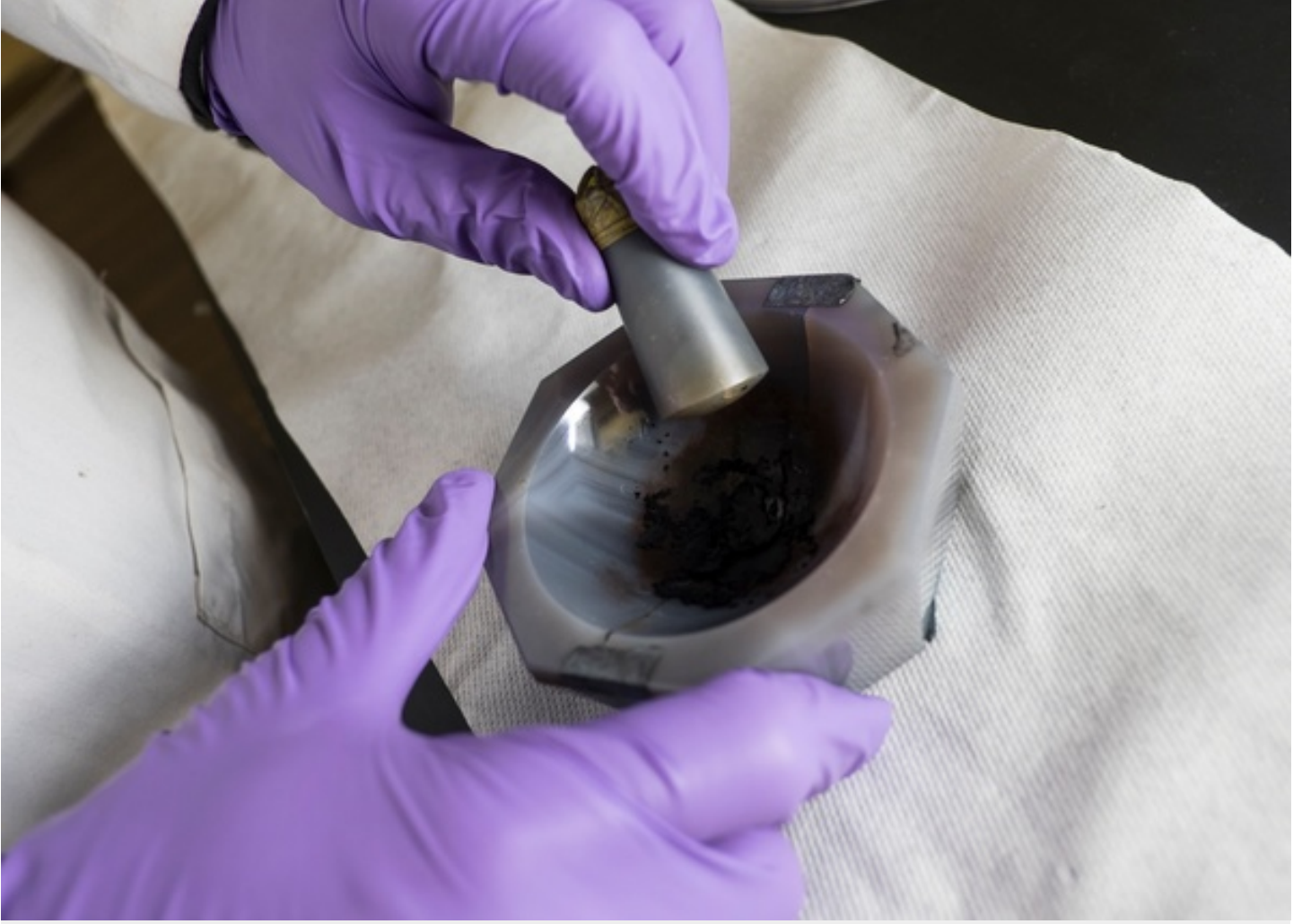
محمد قباني أثناء طحنه الأنابيب النانوية باستخدام المطرقة والهاون. (( Credit: Jeff Fitlow/Rice University
