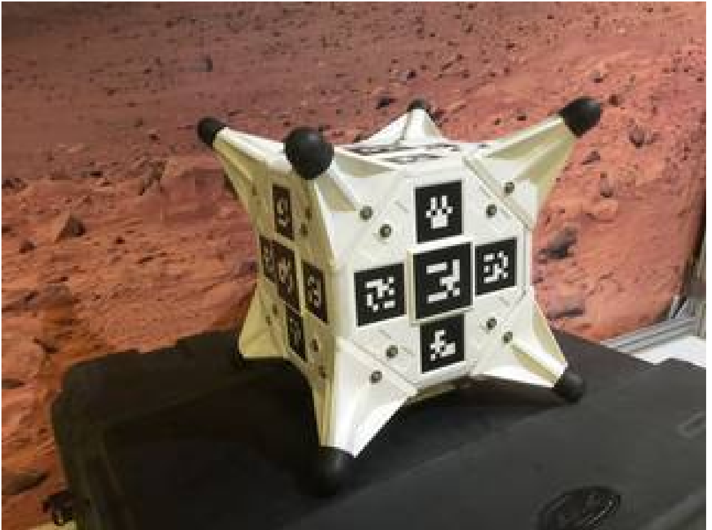
يستطيع روبوت القنفذ الالتفاف عبر دوران وإيقاف حركة العجلات الداخلية باستخدام المحركات والفرامل. المصدر: NASA/JPL - Caltech/Stanford
