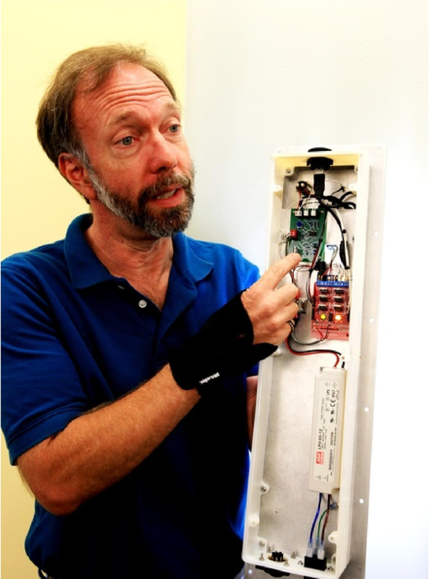
يوضح الباحث الرئيسي الدكتور هولبيرت أن نموذج جهاز الإضاءة الذي تم تطويره في منشأة Swamp Works التابعة لمركز كينيدي، مصنوع أساساً من قطع مصنعة جاهزة ومتاحة بسهولة. يشير هولبيرت في الصورة إلى واحدة من اللوحات الكهربائية في جهاز الإضاءة التي تم تطويرها في قاعدة فلوريدا لإطلاق المركبات الفضائية. يقول هولبيرت: "إذا استطعنا جعل هذه التكنولوجيا جديرةً بالاهتمام، يمكن أن تصبح من التقنيات القيّمة جداً في المستقبل". المصدر: NASA/Kim Shiflett
