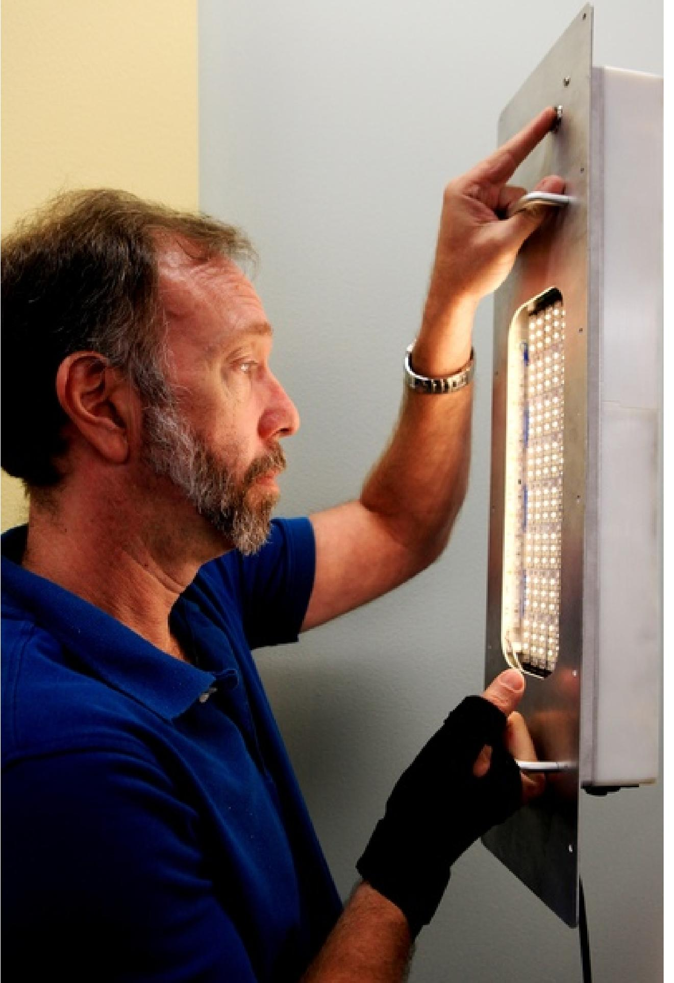
يفحص الباحث الفيزيائي إيريك هولبيرت Eirik Holbert، نموذجاً لجهاز إضاءة يحتمل أن يفتح آفاقاً جديدةً في تكنولوجيا الاتصالات اللاسلكية والتي تُعرف باسم الاتصالات باستخدام الضوء المرئي visible light communication أو اختصاراً (VLC). وعلى غرار الاتصالات عالية السرعة المعروفة باسم واي فاي (Wi-Fi)، فإن هذا المفهوم المعروف بـ اللاي فاي (Li-Fi)، أظهر إمكانية نقل بيانات غير محدودة تقريباً، وباستهلاك طاقة قليل جداً. المصدر: NASA/Kim Shiflett
