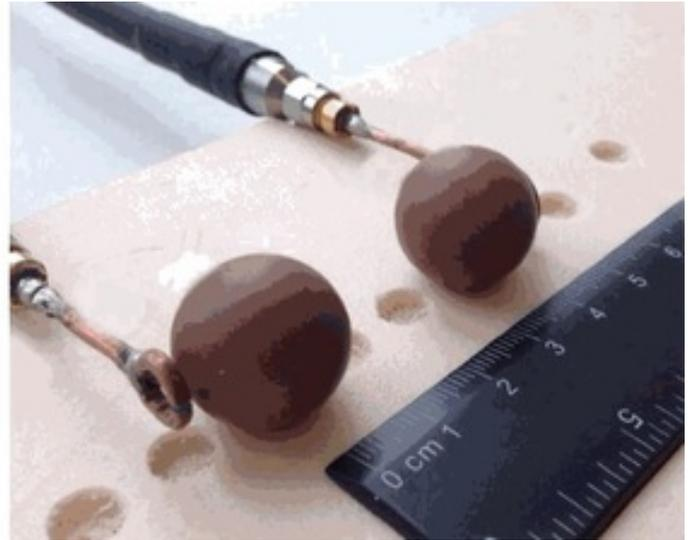
تُظهر الصورة اليسرى توضيحاً لنظام نقل الكهرباء اللاسلكي، بينما تُظهر اليمنى البنية التجريبية، تنتقل الكهرباء من إحدى كرات السيراميك إلى الأخرى عن طريق الرنين المغناطيسي المتماثل للكرتين. المصدر: Song, et al. ©2016 AIP Publishing
