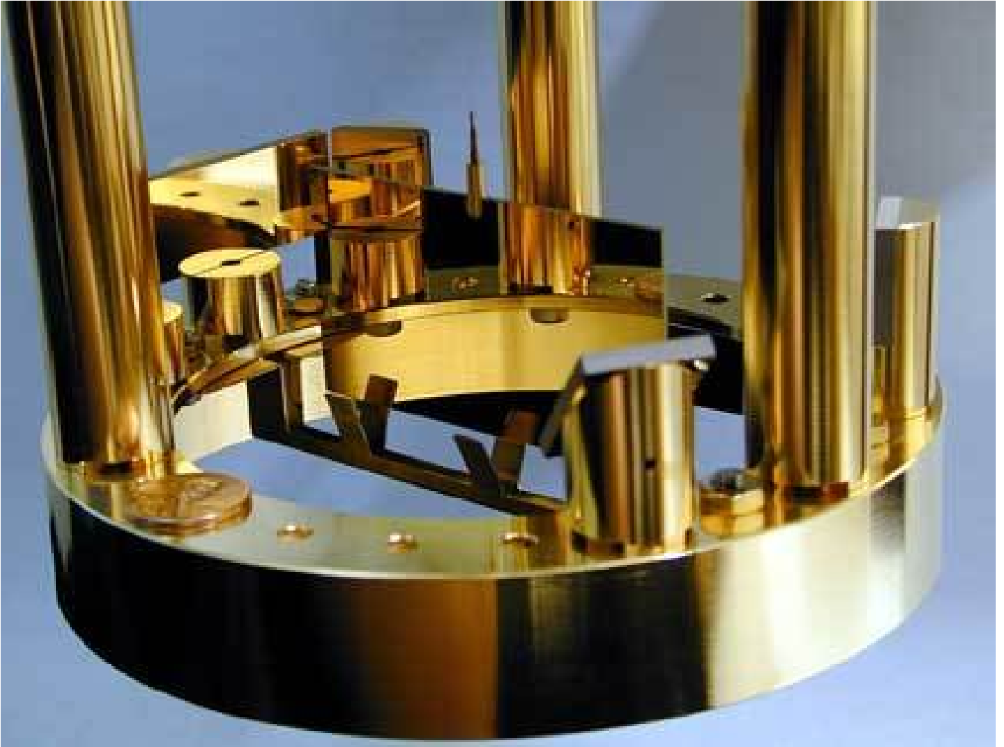
البندول من تجربة ثابت الجاذبية في جامعة واشنطن. المصدر : John Amsbaugh, University of Washington
