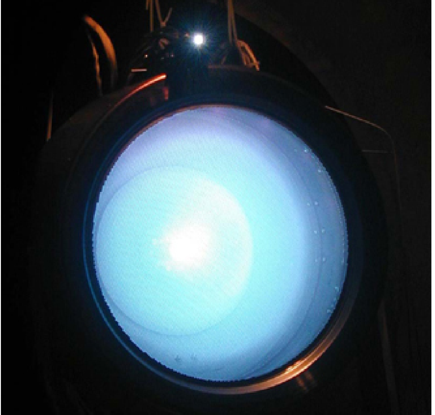
محرك زينون ناسا المتطور NASA Evolutionary Xenon Thruster أو اختصاراً (NEXT)، محرك أيوني أثناء التشغيل
