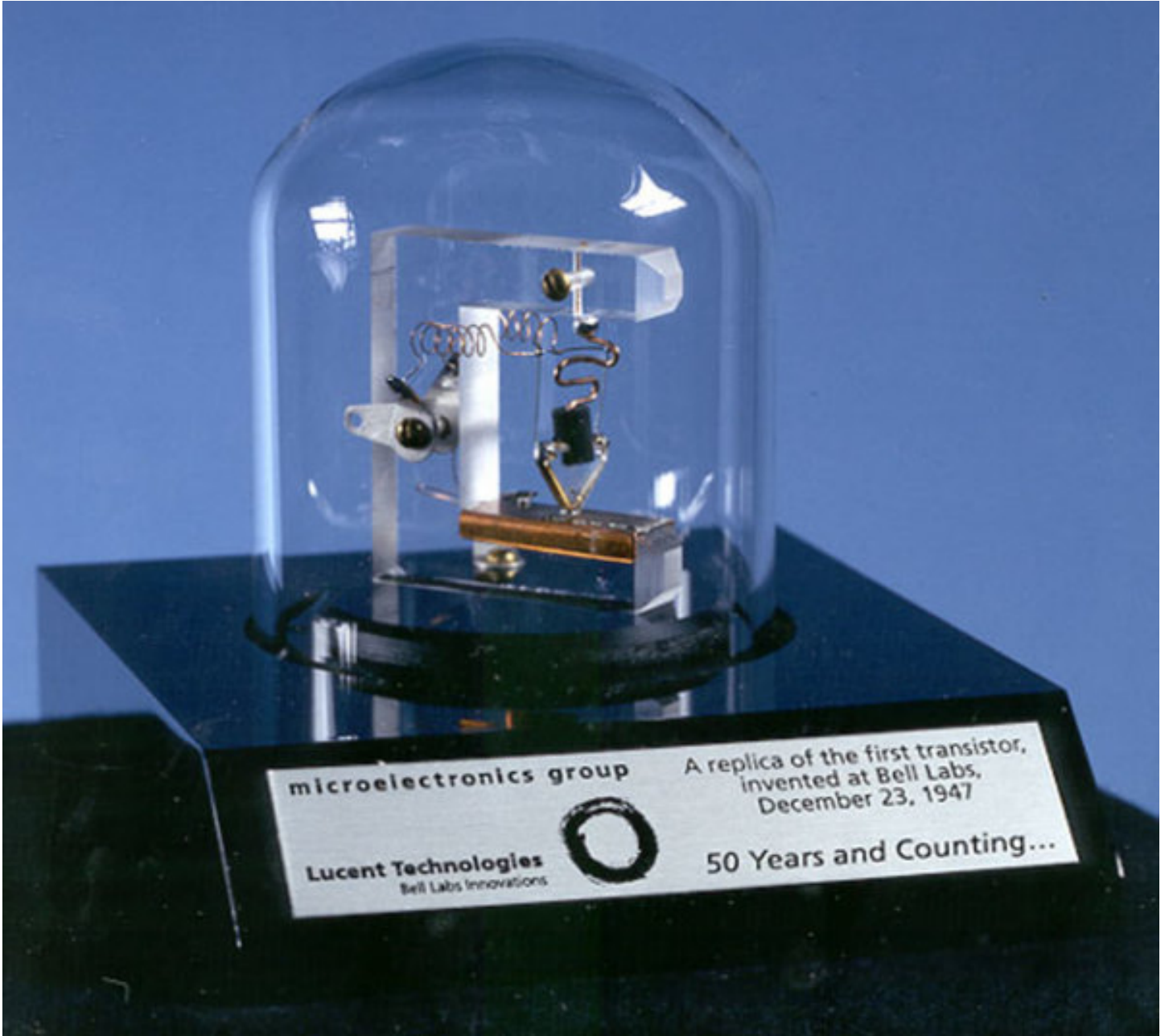
نسخة مطابقة لأول ترانزستور على الإطلاق، تم تصنيعه في مختبرات بل Bell Labs في عام 1947، حقوق الصورة: لوسنت للتكنولوجيا Lucent Technologies
