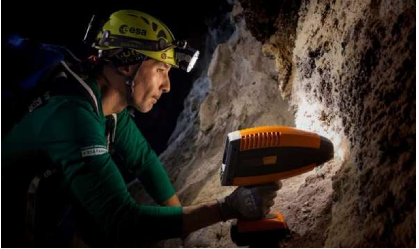
صورة لأحد رواد الفضاء أثناء تفحصه التركيب المعدني للصخور باستخدام مطياف HaloSpec أثناء تدريبهم في أنابيب الحمم البركانية في لانزاروت ضمن برنامج بانغايا 2016. حقوق الصورة: ESA/L. Ricci
