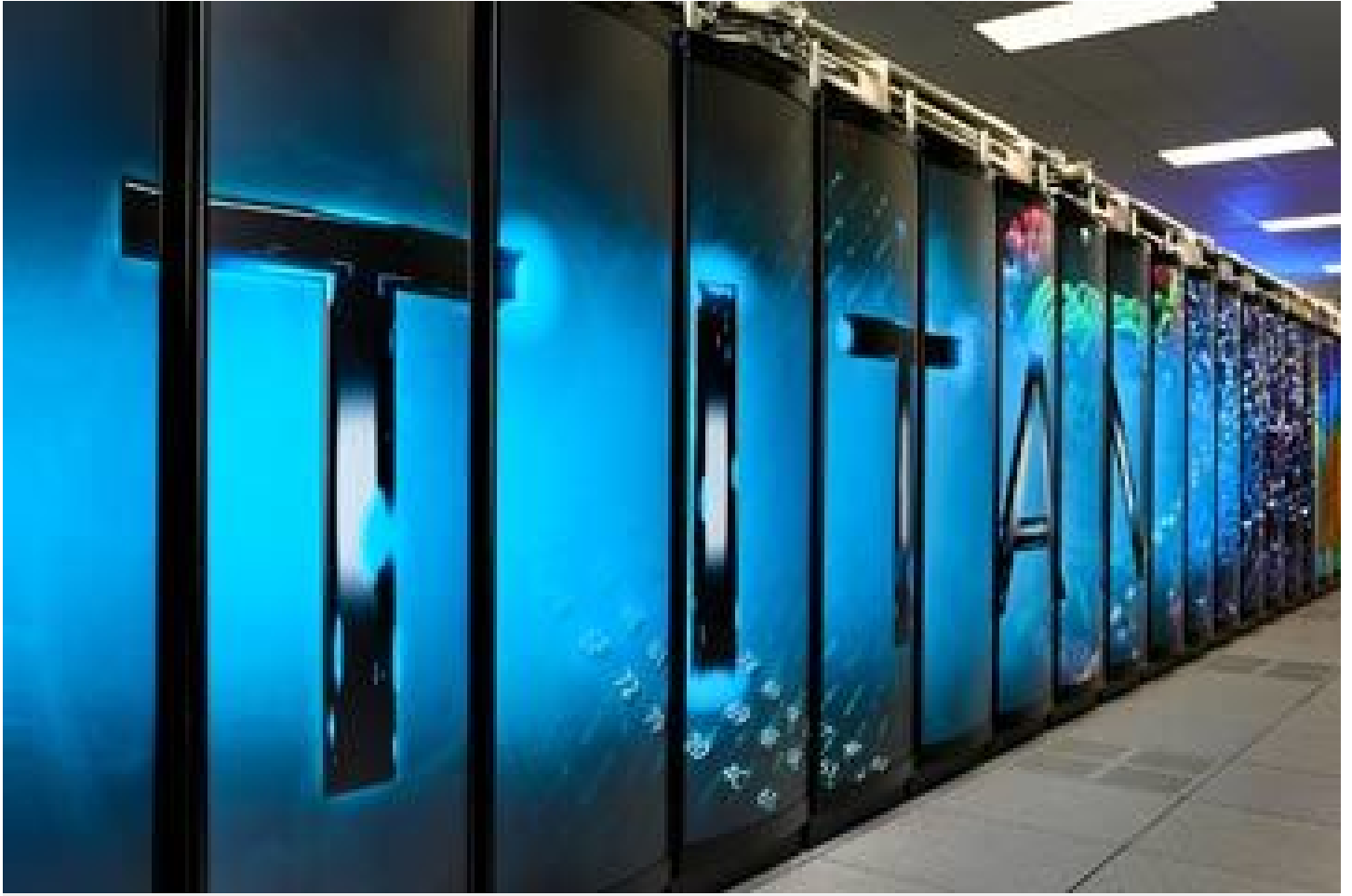
حاسب تيتان الخارق Titan Supercomputer يستطيع القيام بنحو 27000 تريليون عملية حسابية في الثانية
