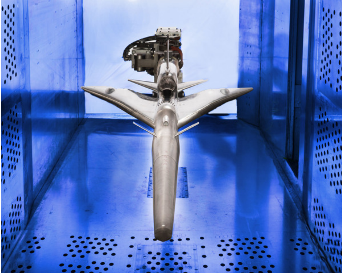
طائرة كويست الاختبارية في نفق الرياح 2.5 × 1.5 × 7 متر. الحقوق: NASA
