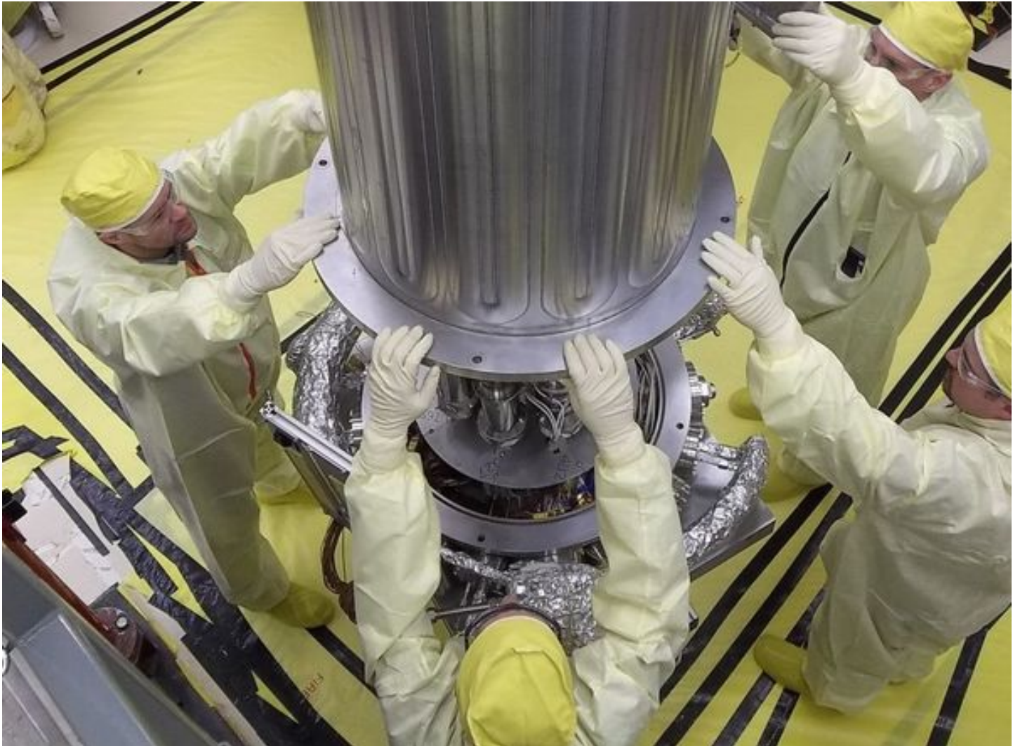
صورة لمهندسي ناسا وNNSA في أثناء إنزالهم جدار غرفة التفريغ حول مفاعل الكيلواط باستخدام تكنولوجيا ستيرلنغ (نظام
