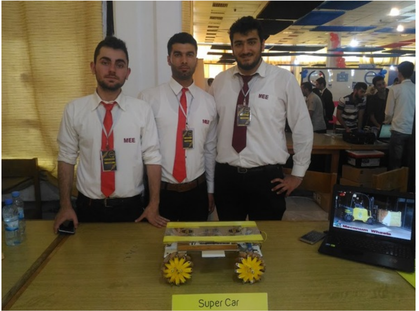
سيارةٍ بعجلاتٍ تتحرك بحيث تكون محصلة القوى بالاتجاه المرغوب للحركة
