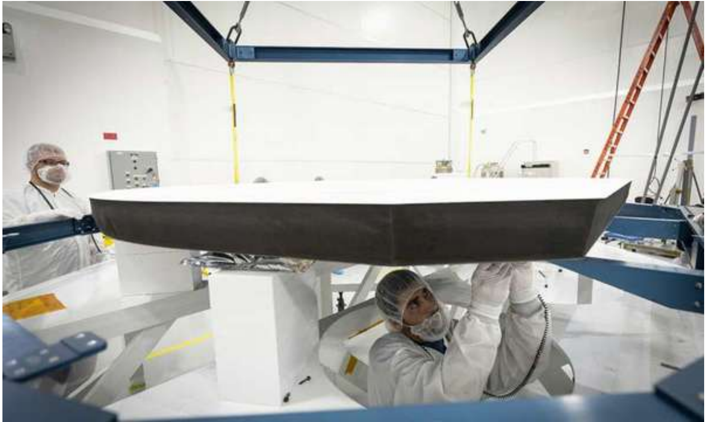
صورة تبين الدرع الحراري ومكوناته والطلاء السيراميكي الأبيض لأحد جوانب الدرع الذي سيواجه الشمس. حقوق الصورة:
