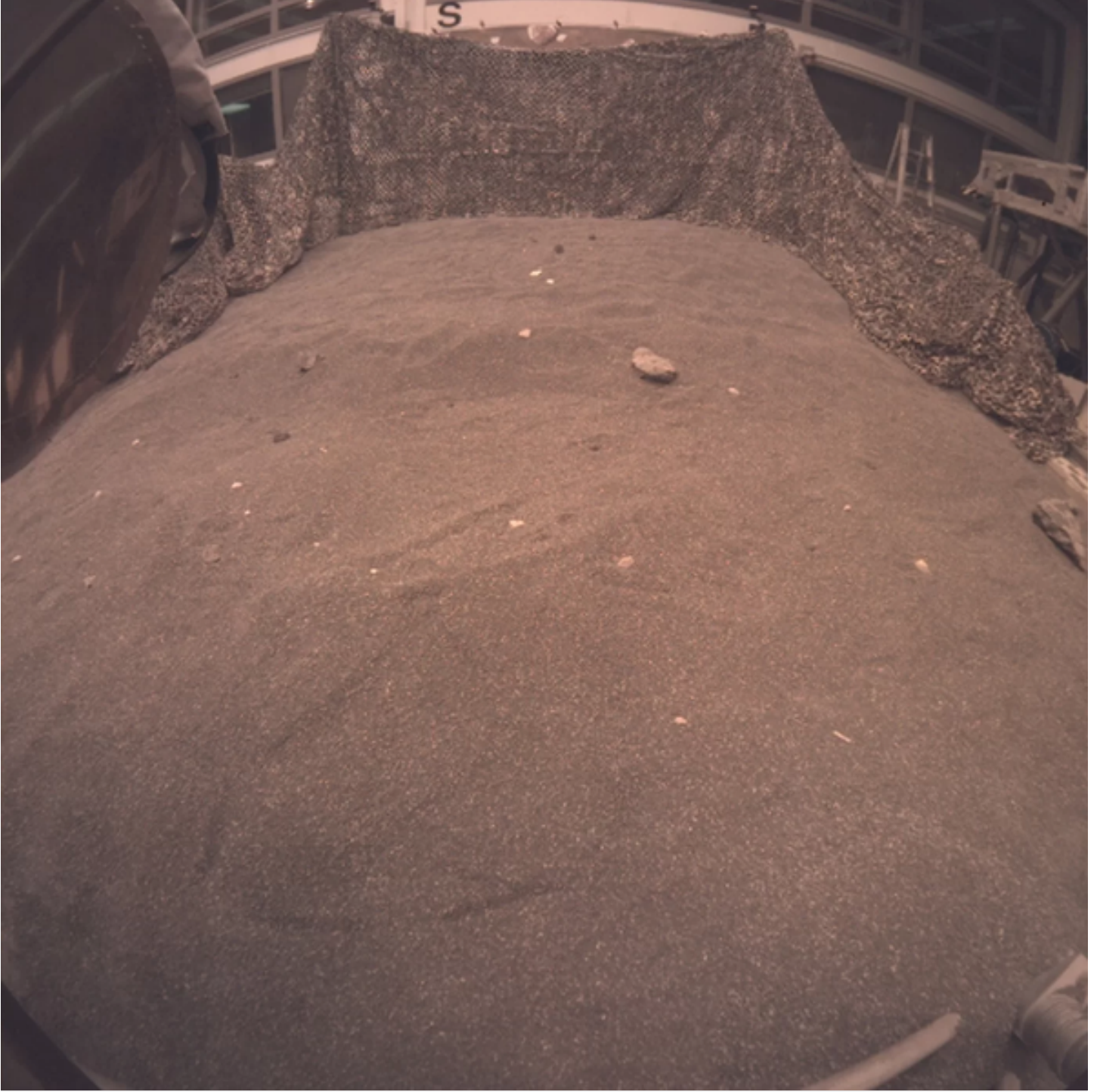
لتقط الصورة النموذج الهندسي لمركبة إنسايت أثناء تجريب نشر أدوات المركبة في تربة مشابهة لتربة المريخ في مختبر الدفع النفاث JPL التابع لناسا في باسادينا، كاليفورنيا. حقوق الصورة: NASA/JPL-Caltech
