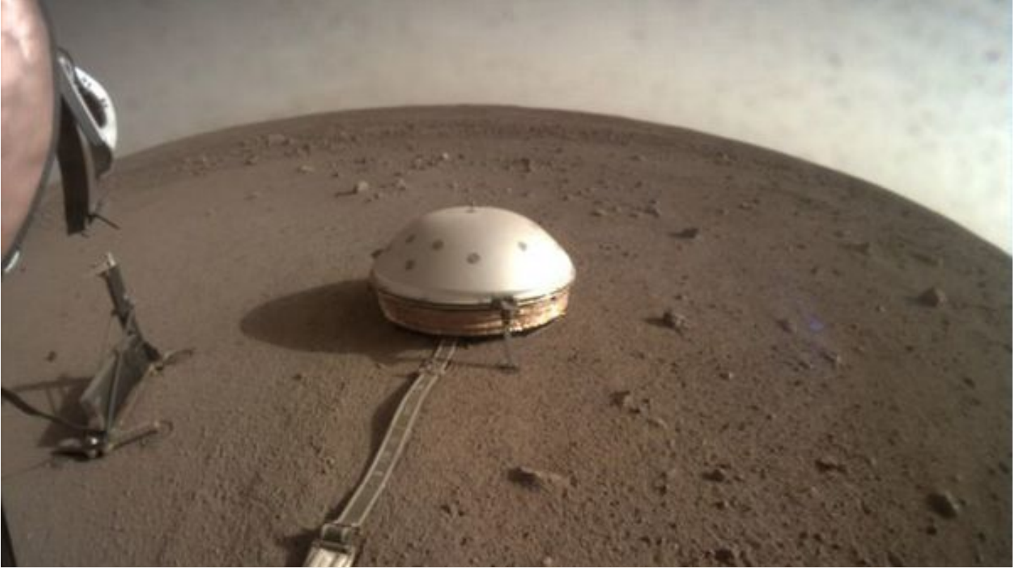
التقطت مركبة انسايت التابعة لناسا هذه الصورة تظهر فيها جهاز رصد الاهتزازات بتاريخ 7 أبريل/نيسان 2019 © Image: (NASA/JPL-Caltech)
