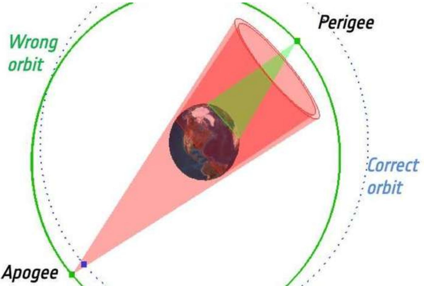
وصلت أقمار غاليليو 5 و6 إلى مدارات خاطئة وطويلة عن طريق المرحلة العليا الخاطئة لصاروخ Soyuz أثناء إطلاقها عام 2014. وهذا ما جعلها غير قادرة على رؤية قرص الأرض عند نقطة الحضيض (أقرب نقطة للأرض) من مدارها. مما يجعل أدواتها الملاحة غير صالحة للاستخدام لأنها تستخدم حساسات أرضية لتركيز حزم إشاراتها. ونجحت المناورات المدارية اللاحقة بجعل مداراتها تأخذ
