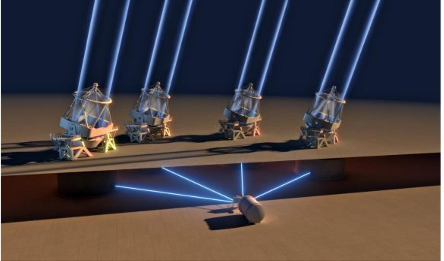
الأداة "ESPRESSO" تجمع الضوء من التليسكوبات الأربعة - التي يبلغ طول قطر كل مرآة فيها 8.2 متراً - تجمعها في المقراب العظيم "VLT" التابع لـ "ESO" في تشيلي. وبسبب منطقة تجميع الضوء الموحدة، فإن هذا التليسكوب هو أكبر تليسكوب بصري موجود. حقوق الصورة: (ESO/L. Calcaada)
