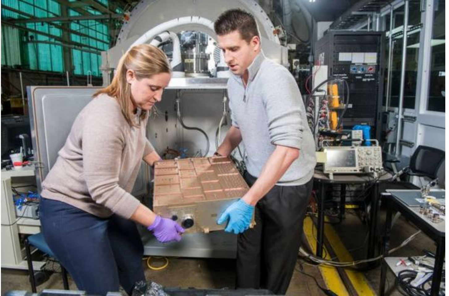
صورة لوحدة معالجة الطاقة "PPU" الخاصة بالدافع، أثناء نقلها من حجرة فراغية أخرى بعد إتمام اختبار ناجح. حقوق الصورة: (NASA/Bridget Caswell)
