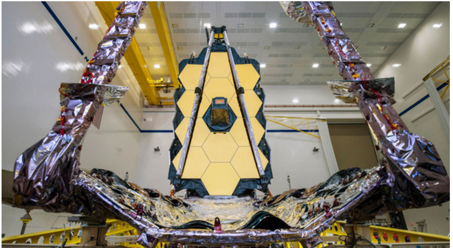
تطوى عدة أجزاء من المرآة إلى الخلف ليكون تموضعها مناسباً ضمن صاروخ أريان5 Ariane5.
