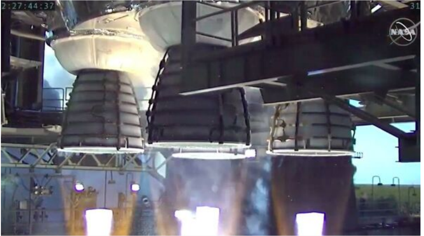
محركات RS-25 المُستخدمة في صاروخ SLS هي نفسها التي استُخدمت في المكوك الفضائي. حقوق الصورة: NASA
