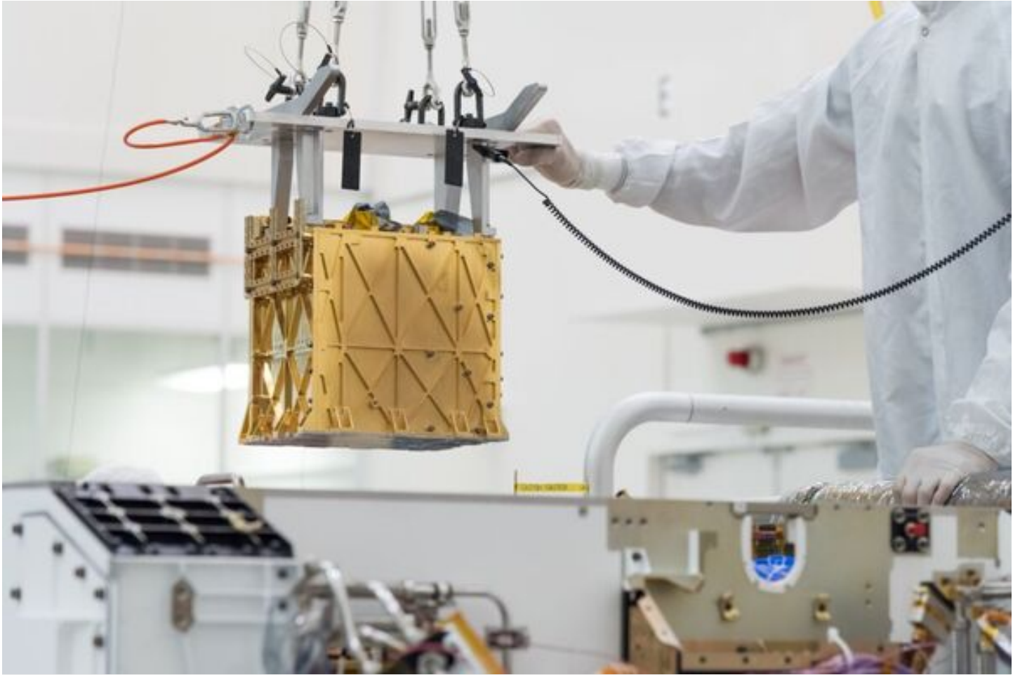
قام المهندسون بتركيب أداة موكسي على متن مركبة بيرسيفيرانس الجواله في مارس 2019. حقوق الصورة: NASA/JPL-Caltech
